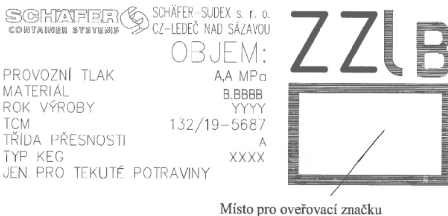
Obr. č. 2 Vzor štítku s identifikačnými údajmi a miestom pre overovaciu značku
